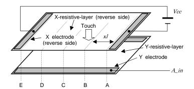
Vcc = 5.0Vχl A in **Output Data** 0V Α 0000h (Min.) В 1.25V 00FFh С 2.5V 01FFh D 3.75V 02FFh Е 03FFh (Max.) 5V
